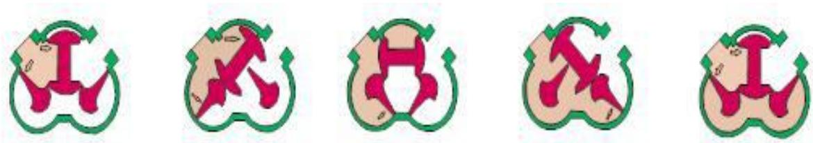
转子处于起始状态    转子转动 90°    转子转动 180°    转子转动 270°    转子转动 360°
